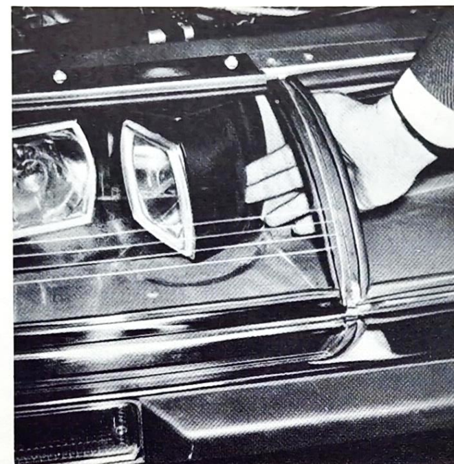
Afb. 33 – Het met de hand verdraaien van de draaibare koplampen
