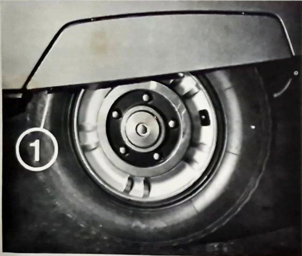
Afb. 30 – Het verwijderen van de dekplaat (laatste uitvoering)
